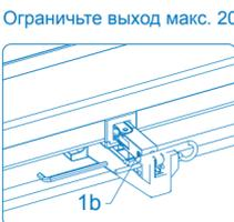
**W** - Чтобы обеспечить максимальную упругость цепи во время фазы открывания, включите привод и дайте ему поработать до тех пор, пока не выйдет примерно 5 см цепи. Затяните винт «1b» сбоку головки с помощью шестигранного ключа (не входит в комплект).
