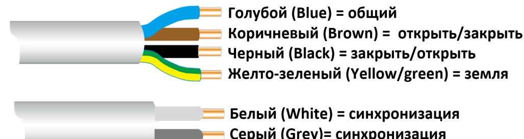
В случае использования привода **PRO СИНХРО (AM56)** для одиночной работы, кабель синхронизации не используется. Убедитесь, что на проводах Серый (Grey) и Белый (White) для синхронизации работы нет напряжения, иначе приводы могут выйти из строя.
