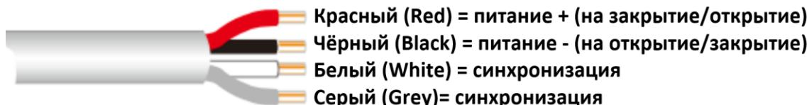
Низковольтный привод 24V (DC) может быть подключен к источнику питания постоянного тока 24V (DC) (-15% ÷ +15%). Кабель должен соответствовать второму классу безопасности (двойная изоляция).
